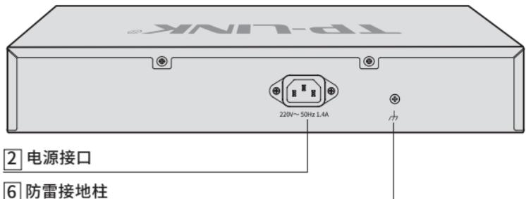
图1-3 TL-SG2210PE后面板示意图
