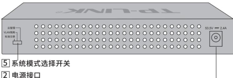
图1-5 TL-SG2210PT后面板示意图
