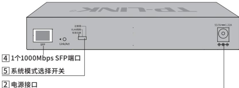
图1-7 TL-SG2210P后面板示意图
