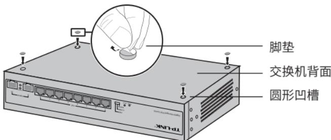
图2-1 桌面安装示意图
